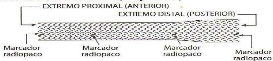
Figura 2B: Endoprótesis de rama contralateral (Diámetros ilíacos distales: 16, 18 y 20 mm)
